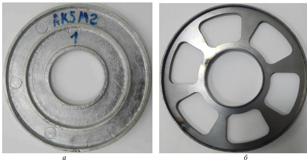
Рис. 1. Междупильные прокладки линтерной машины: а – AK5M2; б – Сталь 3
