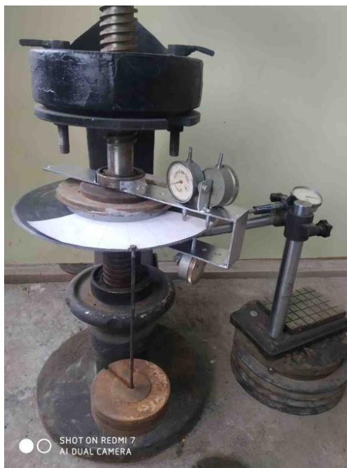
Рис. 3. Фотоснимок экспериментального стенда по изучению изгиба пильных дисков
